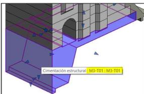
Modelamos las Trabas de cada Bloque, Editamos el Elemento IN SITU M3-T01, Cortamos los Fundidos con una forma vacía, Editamos el resto de las Tongadas, Modelar los huecos de las Trabas, Modelar huecos del resto de las Tongadas, Identificar elementos IN SITU en el Navegador, Probamos de Copiar y Pegar Tongadas
